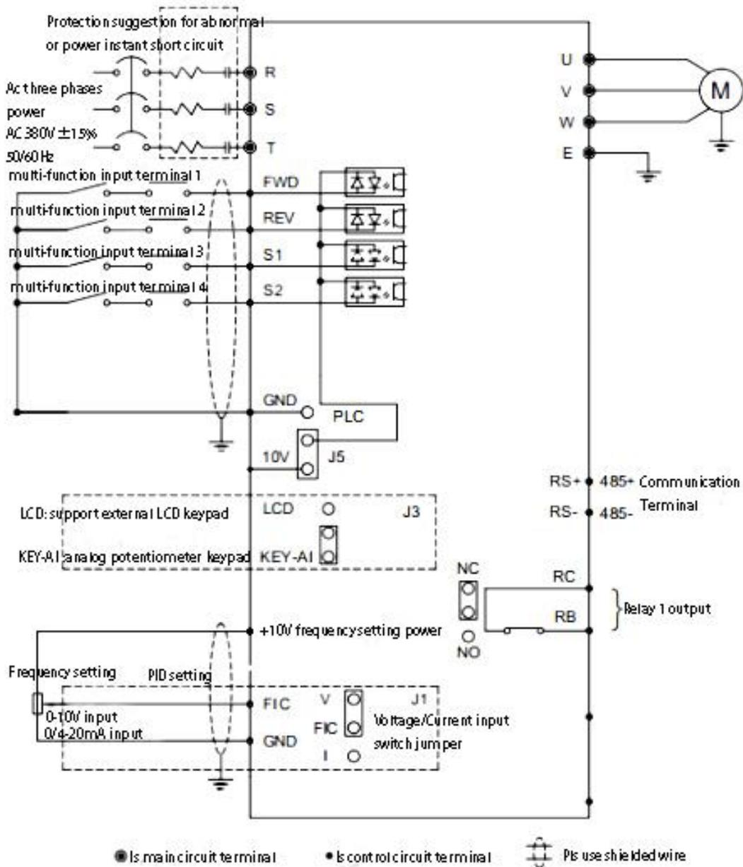
2) 1PH/220V 0.4-3.7kW & 3PH/380V 0.4-5.5kW
